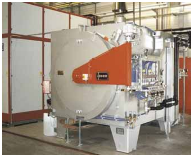
Uusi vakuuminitrausuuni, jonka kammion suurimmat mitat ovat 1100 x 1100 x 1200 mm.
