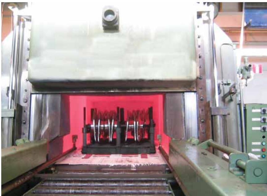
Hammaspöörin hiiletyskarkaisua. Käsittelyn tuloksena hampaiden kulumiskestävyys ja väsymislujuus paranee runko-osan säilyessä sitkeänä.
