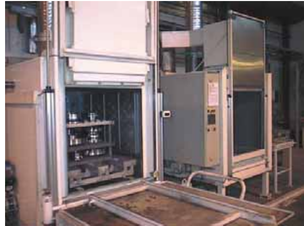
Asiakkaiden teräskappaleet pestään ja kuivataan ennen lämpökäsittelyä. Työstönesteiden jäämät heikentävät erityisesti pintakarkaisun lopputulosta.
