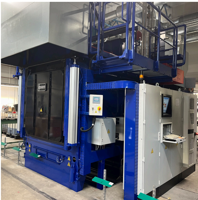
En av ugnarna för skyddande atmosfär
